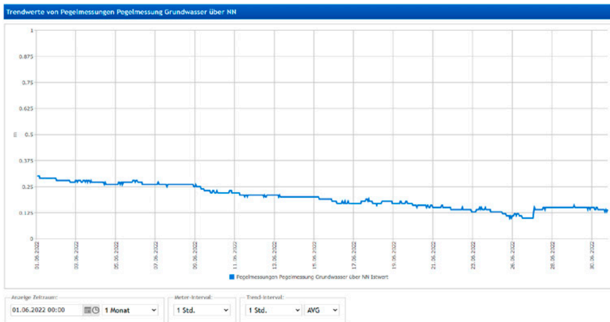
Abbildung 17: Darstellung des Grundwasserspiegels in der Gebäudeleittechnik
